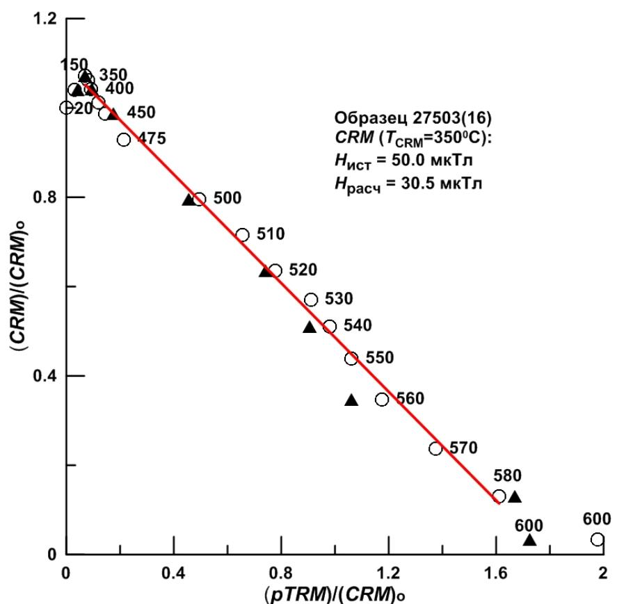
Пример диаграммы Араи-Нагата, построенной по результатам применения процедуры Телье на образце базальта с лабораторно индуцированной химической остаточной намагниченностью. Химическая остаточная намагниченность создана на исходном образце в течение 200-часового отжига при  $350^{\circ}\text{C}$  в присутствии постоянного магнитного поля напряженностью 50 мкТл; расчетное значение поля составило 30.5 мкТл.
